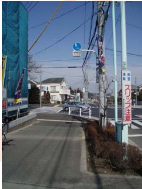
著しく高所に設けられた既存標識の例
